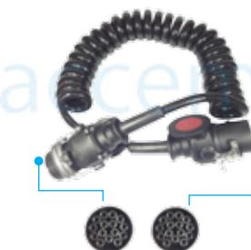
15-pol. Wendelleitung (12 x 1,5 mm<sup>2</sup> + 3 x 2,5 mm<sup>2</sup>) 24 V PUR mit einem Wendeldurchmesser von 35 mm.
